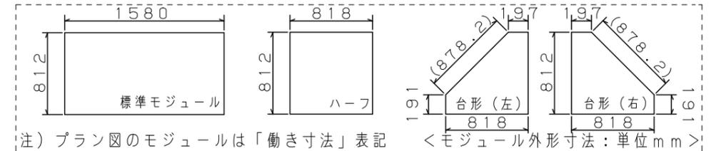
注) プラン図のモジュールは「動き寸法」表記 <モジュール外形寸法:単位mm>
